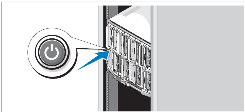
各ブレードの電源ボタンを押すか、またはシステム管理ソフトウェアを使用してブレードの電源を入れます。
