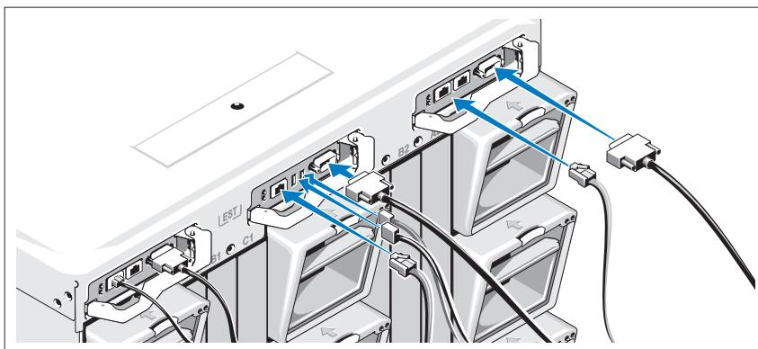
管理システムと CMC モジュールをシリアルケーブルとネットワークケーブルでつなぎます。2 台目のオプションの CMC モジュールを取り付けた場合は、同様にケーブルを接続します。
