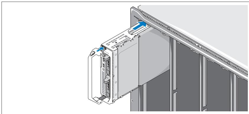
最上部から始めて、左から右の順にモジュールをエンクロージャに挿入して取り付けていきます。プレードが固定されたら、ハンドルが閉じ位置に戻ります。
