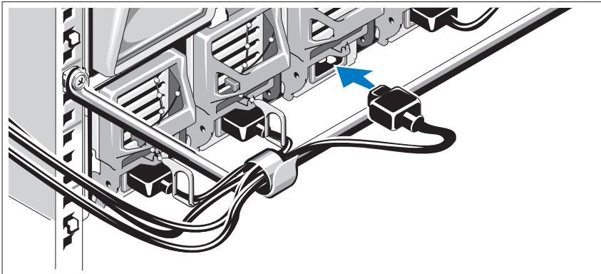
将系统的电源电缆连接到系统电源设备上。
