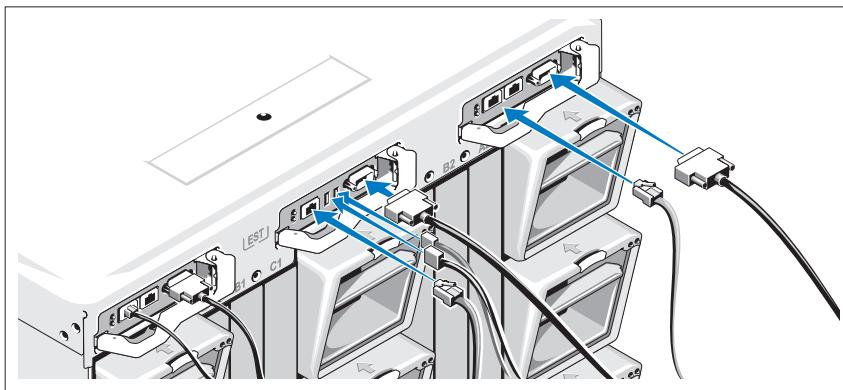
将串行电缆和网络电缆从管理系统连接到 CMC 模块。如果安装了第二个可选的 CMC 模块，也将其连接。
