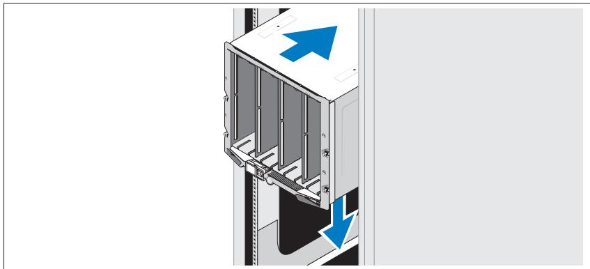
인클로저와 함께 제공된 안전 지침 및 랙 설치 지침에 따라 레일을 조립하고 시스템을 랙에 설치합니다.
