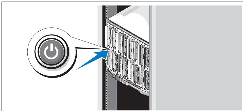
按下每个刀片上的电源按钮，或者使用系统管理软件打开刀片的电源。
