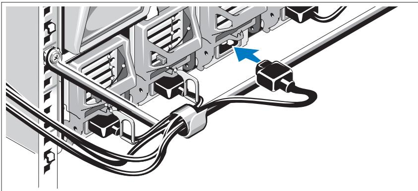
システムの電源ユニットに電源コードを接続します。
