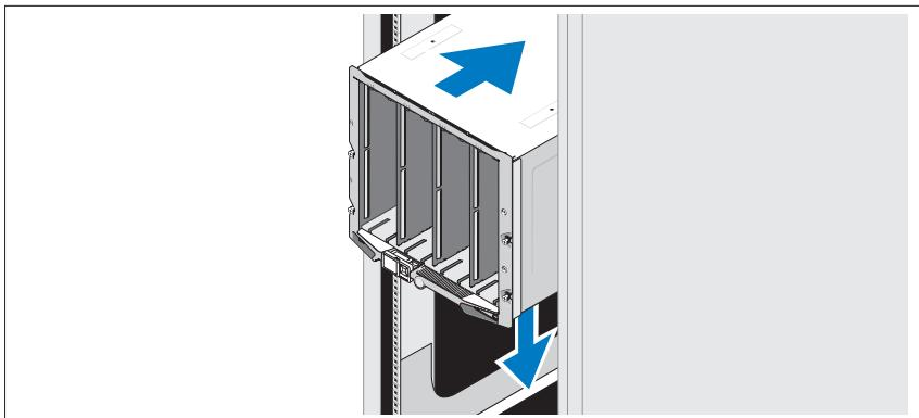
遵循机壳随附的安全说明和机架安装说明，在机架中组装滑轨并安装系统。
