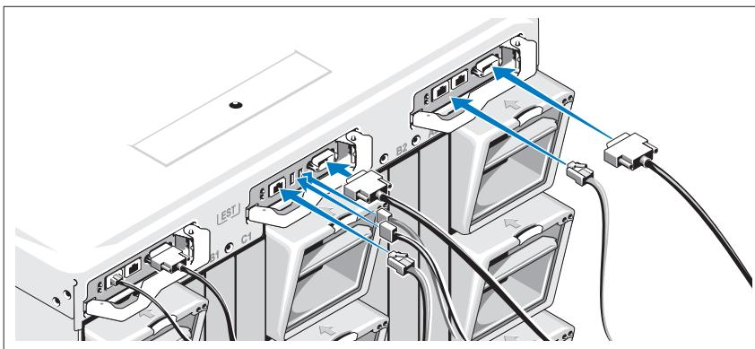
Hubungkan kabel serial dan kabel jaringan dari sistem manajemen ke modul CMC. Jika modul CMC opsional kedua dipasang, hubungkan juga modul tersebut.
