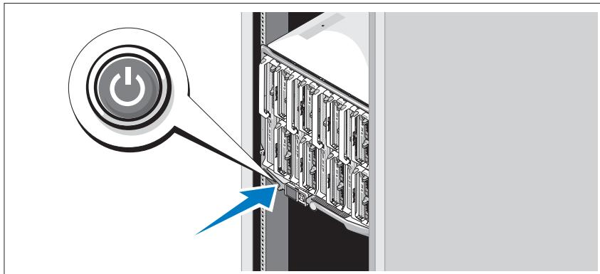
エンクロージャの電源ボタンを押します。電源インジケータが点灯します。
