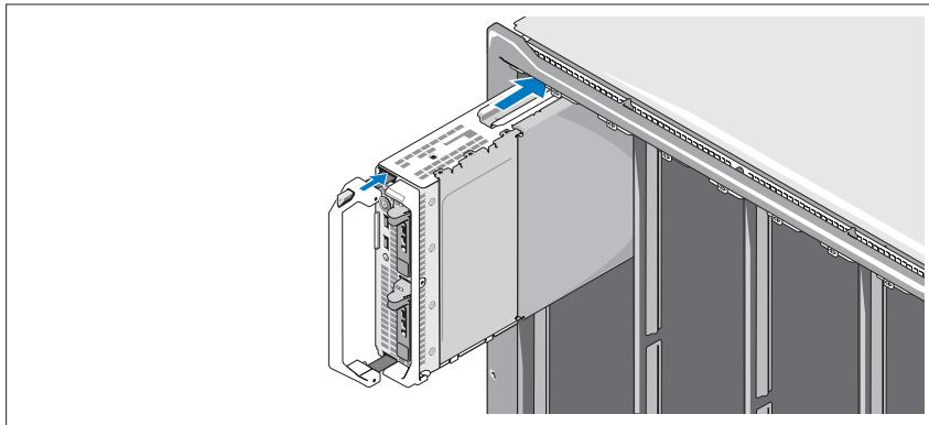
从上面开始，将模块从左向右滑入机壳中。稳固地安装好刀片后，手柄返回到关闭位置。
